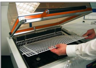
Réglage en hauteur du plateau permettent d'ajuster le niveau de la soudure périphérique par rapport à la hauteur du produit pour obtenir une rétraction parfaite homogène autour du produit. Et barre de soudure téflonnée pour une durée de vie accrue.
